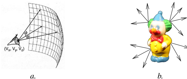
FIG. 1 – a. La fonction plénoptique exprime le flux lumineux émis par un point (V_x, V_y, V_z) et dans toutes les directions (\theta, \phi) ; b. Cette fonction peut être utilisée pour représenter les flux lumineux émis par la surface d'un objet.
