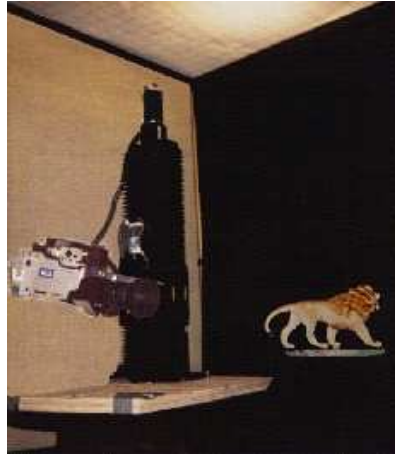
FIG. 1.4 – Système d'acquisition d'un lightfield. L'objet est placé au centre, l'éclairage de la pièce est constant. La caméra se déplace autour de l'objet pour réaliser l'acquisition
