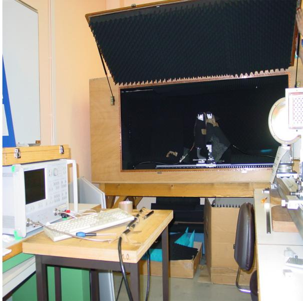
FIG. 4.20 – Chambre anéchoïque servant aux mesures.
